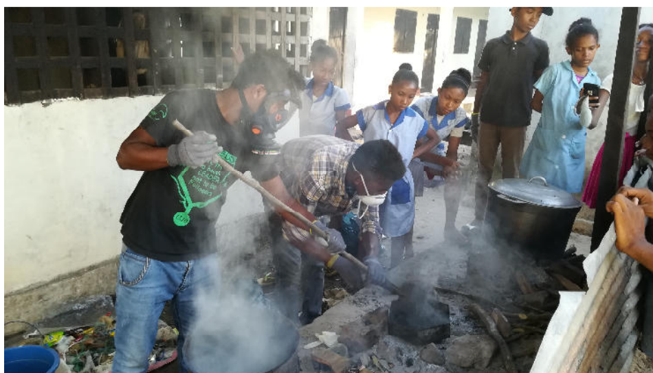
Foto Nr. 6: Herstellung eines Pflastersteins aus Plastik und Sand
